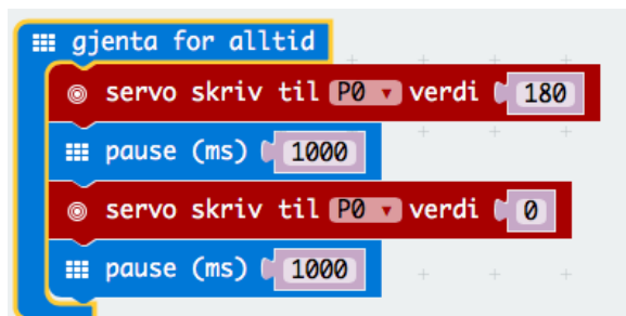
Bilde 2: enkelt program som skrur på og av strøm til servoen med 1 sekunds intervall (1000 millisekund)
